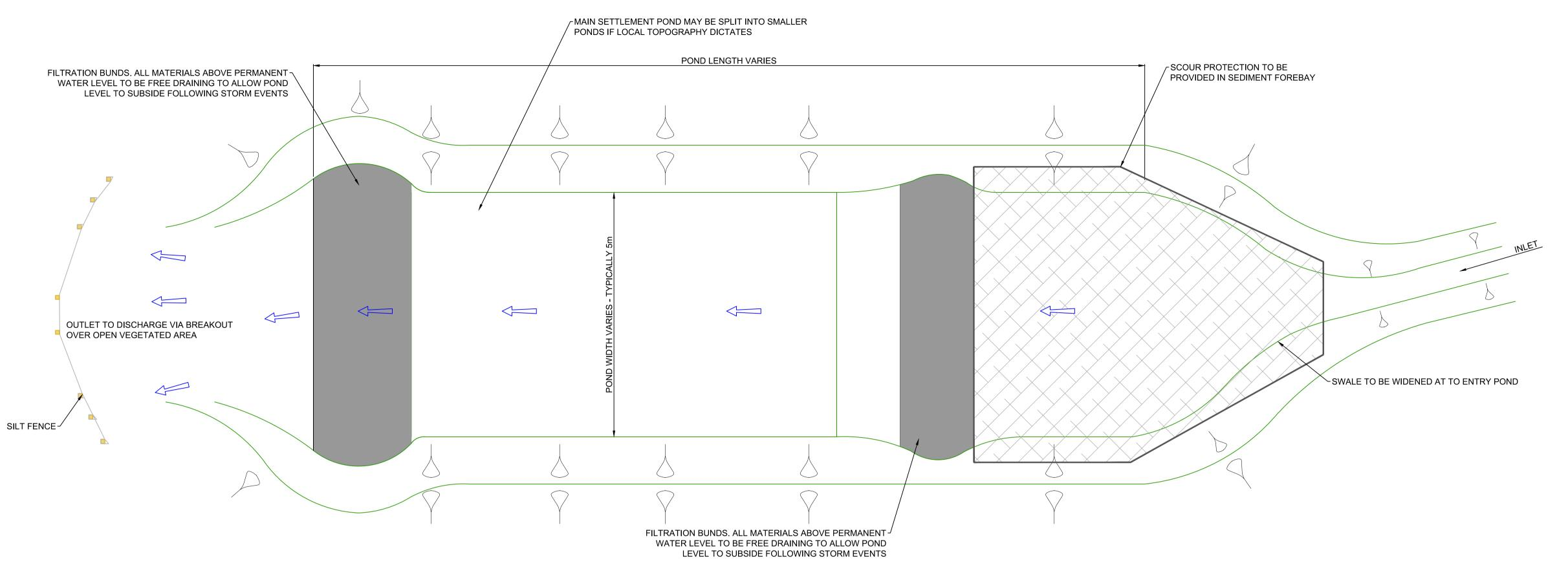
TYPICAL SETTLEMENT POND DETAIL - PLAN SCALE - 1:50
