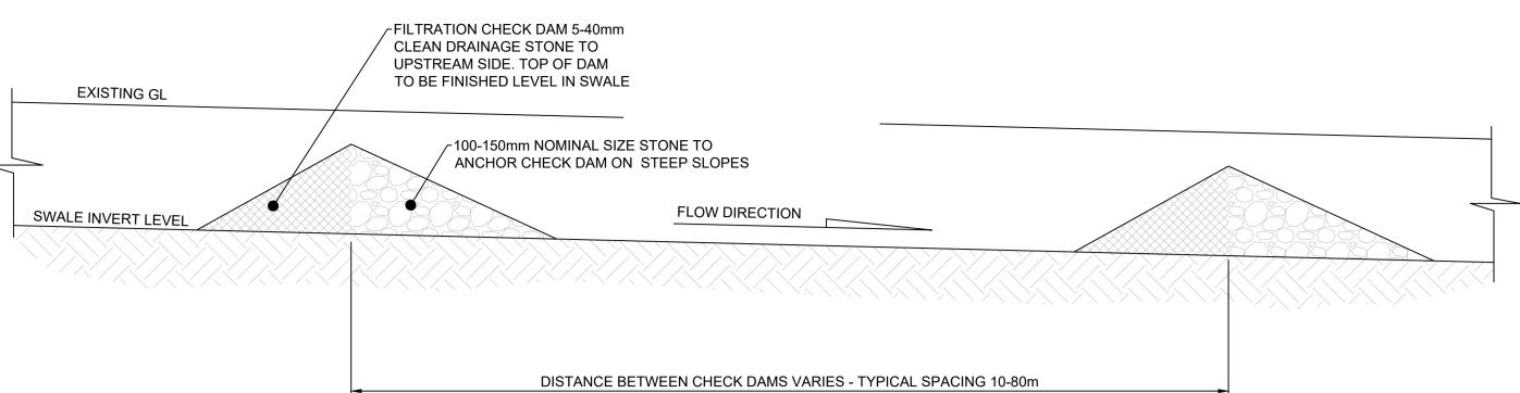
TYPICAL TRACKSIDE SWALE - LONG SECTION SCALE - 1:20
