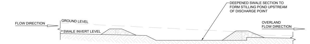
TYPICAL OVERLAND BREAKOUT - LONG SECTION SCALE - 1:50
