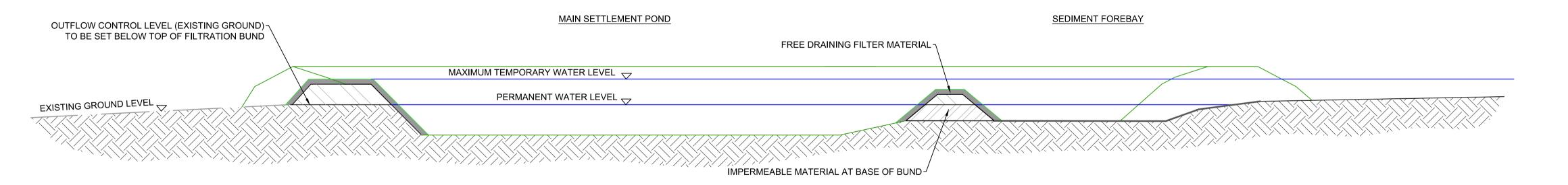
TYPICAL SETTLEMENT POND DETAIL - LONG SECTION SCALE - 1:50
